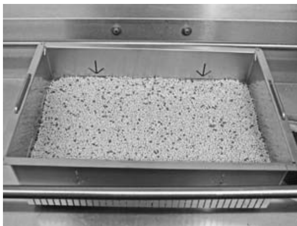
Obrázek 21: Kontrola hladiny granulí
