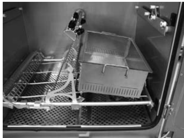
Obrázek 20: Sběrače granulí uvnitř myčky
