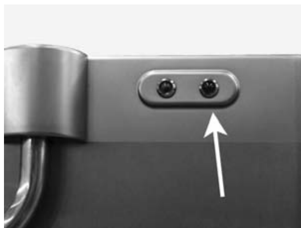
Obrázek 16: V průběhu vykonávání programu svítí červená kontrolka.
