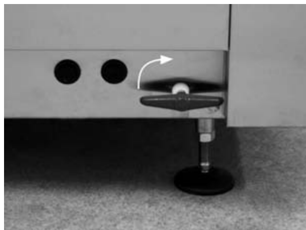
Obrázek 25: Otevřete vypouštěcí ventil
