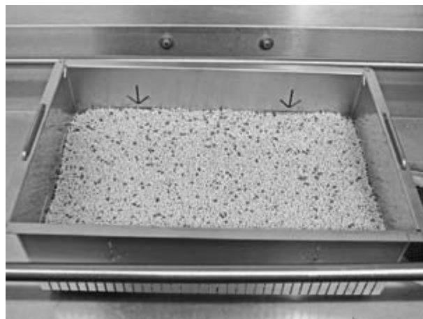
Obrázek 24: Kontrola hladiny granulí
