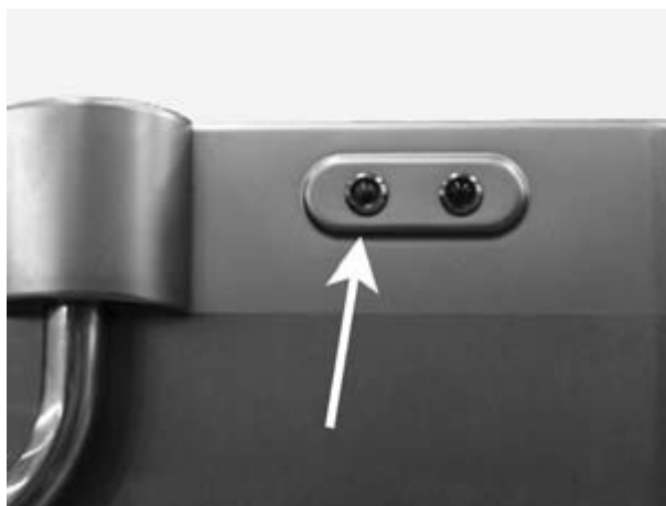
Obrázek 17: Po dokončení programu se rozsvítí zelená kontrolka.
