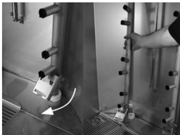
Obrázek 22: Removing spray pipe
