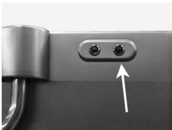
Obrázek 16: V průběhu vykonávání programu svítí červená kontrolka.
