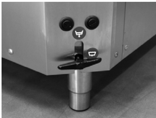
Obrázek 19: Přístup k ochraně proti přehřátí
