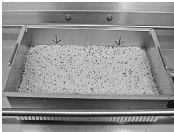
Obrázek 23: Kontrola hladiny granulí
