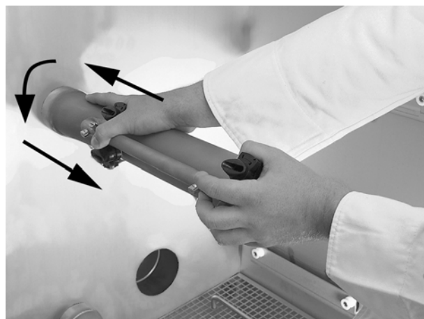
Obrázek 23: Removing spray pipe
