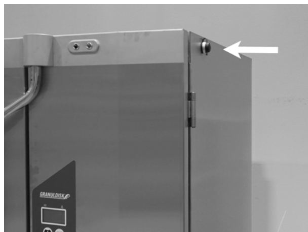
Obrázek 31: Port USB se nachází pod černou krytkou umístěnou na pravé straně myčky.
