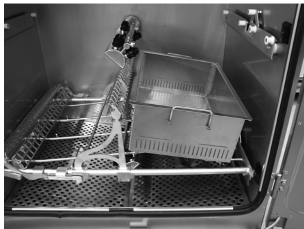
Obrázek 21: Sběrače granulí uvnitř myčky
