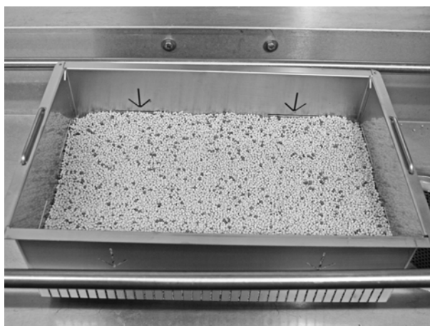
Obrázek 21: Kontrola hladiny granulí
