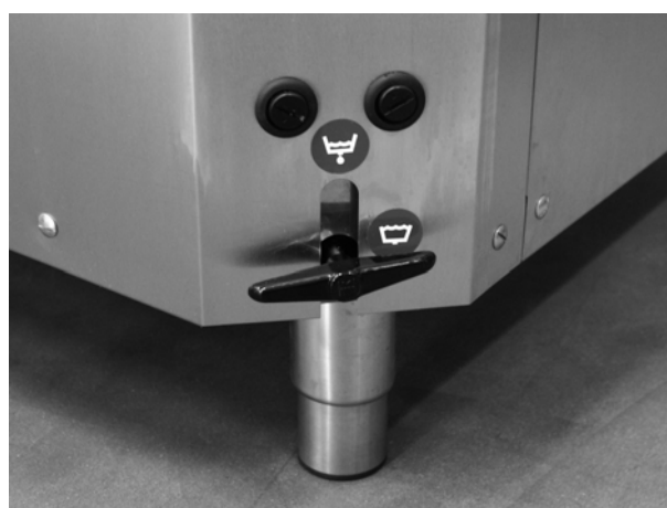
Obrázek 17: Přístup k ochraně proti přehřátí
