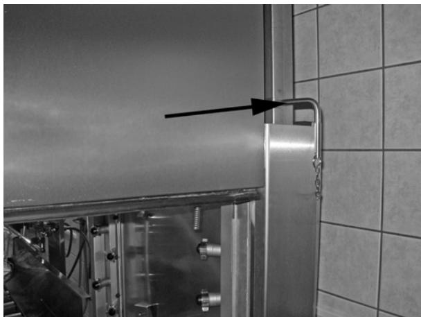
Obrázek 27: Pojistka ochranného krytu
