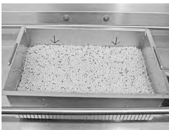
Obrázek 21 Kontrola hladiny granulí
