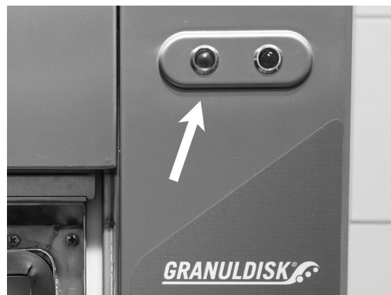
Obrázek 23 Po skončení programu se rozsvítí zelená kontrolka.
