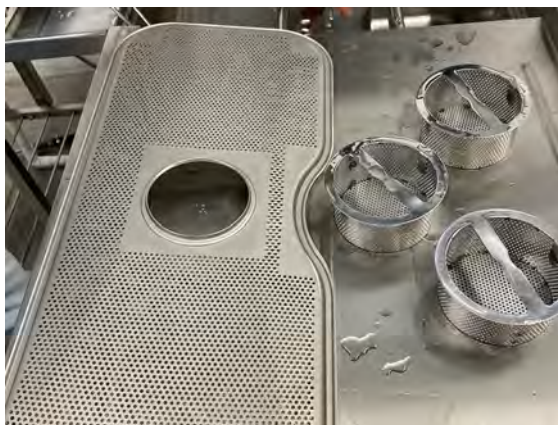
Obrázek 23 Očištění filtrů a mřížky nádrže
