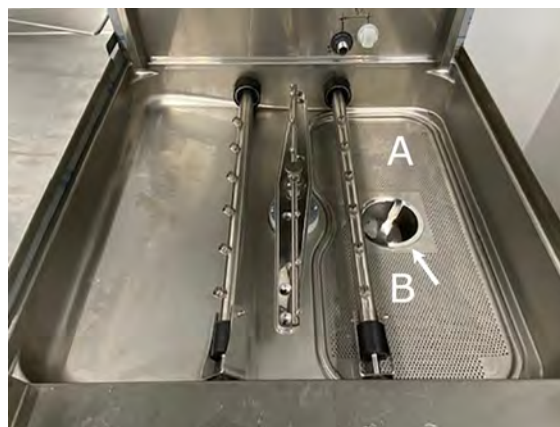
Obrázek 21 Vyjmutí mřížky nádrže a filtru
